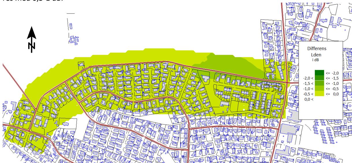
Figur 27: Differenskort. Figuren viser effekten af hastighedsreducerende tiltag på Vejrmøllevej. Beregningshøjde 1,5 m over terræn.
