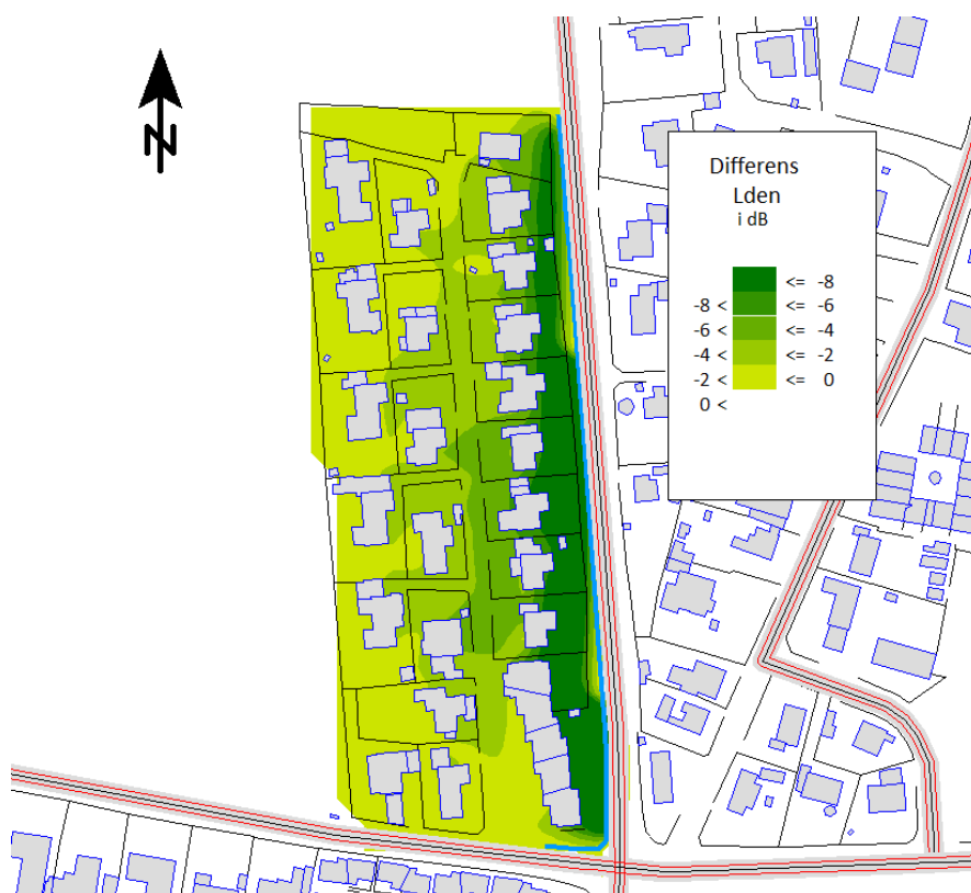
Figur 30: Differenskort. Figuren viser effekt af etablering af en 3 m høj støjskærm langs med Hillerødvej i Lyngby. Beregningshøjde 1,5 m over terræn.
