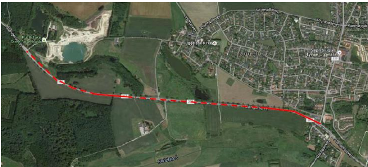
Figur 7 Køen fra vest mod øst fra krydset ved Hillerødvej. Den røde streg viser hvor der ofte opstod stillestående kø og den stiplede linje viser, hvor der oftest var rullekø (ca. 20-25 km/t). Kilde: Trafikafvikling Slangerupvej/Hillerødvej, Køudvikling, 2016.
