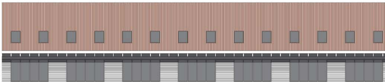
Placering af tagvinduer, princip 1
