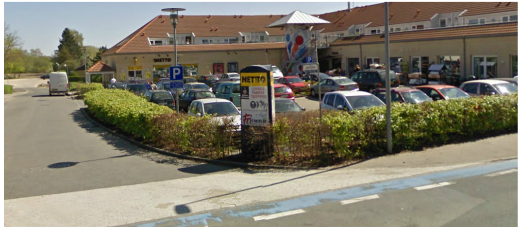
Figur 9. Overkørslen til Lyngby Bytorv. Bemærk reklamestander, der begrænser udsynet for udkørende.
