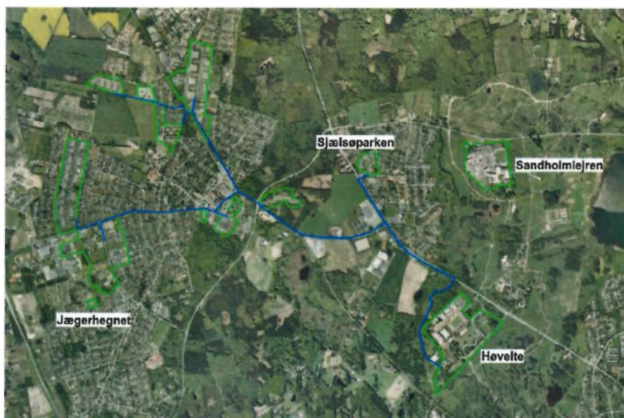
Figur B 1 Blokvarmecentraler/lokale fjernvarmeforsyninger (grønne afgrænsninger) og transmissionsledninger fra Høvelte til blokvarmecentralerne/de lokale fjernvarmeforsyninger (blå linjer)
